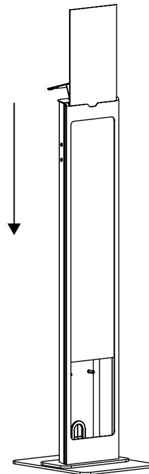
ベースプレートと本体底面プレートのボルト穴を合わせる
